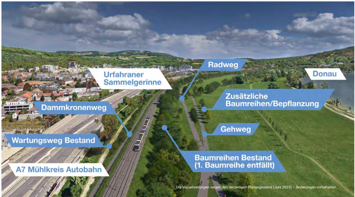
Abb. 3.: Die geplante S7 führt entlang des Hochwasserschutzdammes bis nach Linz Auhof. Der Hochwasserschutzdamm bleibt ein Ort der Erholung und Natur. Dank professioneller und umsichtiger Planung wird der wertvolle Lebensraum für Flora und Fauna geschont. Mit der Dammverbreiterung Richtung Donau wird zudem der Hochwasserschutz verstärkt.
